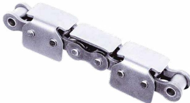
Esempio di utilizzo: movimentazione di pezzi che si possono accumulare sul trasportatore, la catena continuando ad avanzare e i pezzi scivolando grazie alle alette smussate. Questi smussi impediscono di segnare i prodotti convogliati. Si possono realizzare le catene anche in versione doppia.
