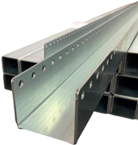
Profilo a U con foratura multipla a passo 26mm. Il profilo è di lunghezza 2990mm ed è intestato per ottenere il primo foro a 13mm.
