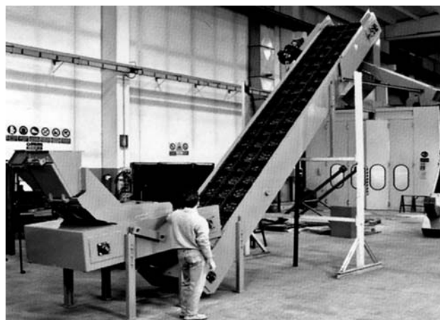
Trasportatore per evacuazione pezzi stampati a caldo su piste separate Conveyor for evacuation of drop-forged pieces on separated tracks
