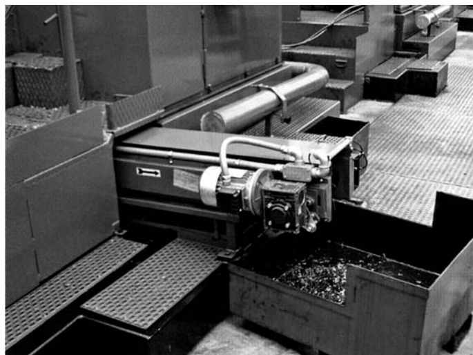
Trasportatore rettilineo per estrazione sfridi da stampatrice Rectilinear conveyor for extraction of scraps from cold header
